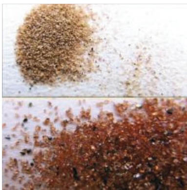
Vergleich von zwei Schneidstoff-Körnungen für feinen (links) und für groben Schnitt. Die geringe Streuung der Korngrößen ist deutlich zu erkennen.
